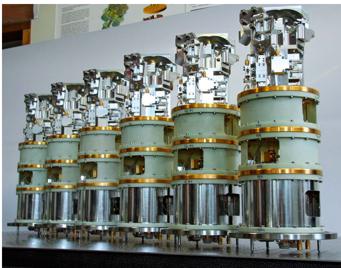
Zes van de 73 ALMA Band-9 ontvangers die NOVA in 2009 – 2012 heeft gebouwd en geleverd. ( eso.org )
