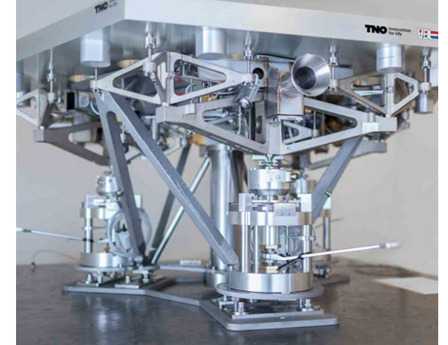
Foto 3: Prototype van de mechanische ondersteuning van een segment van de ELT hoofdspiegel (M1). De hoofdspiegel bestaat uit 798 van dit soort segmenten. De mechanische ondersteuning zorgt ervoor dat het spiegelsegment, met een diameter van 1.4 m, de vereiste vorm met een tolerantie van 25 nm kan bereiken en behouden.
